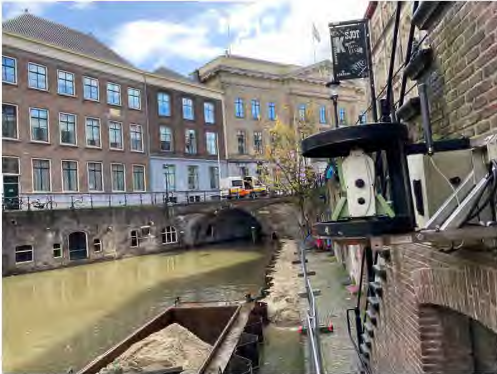
Figuur 5: Voorbeeldfoto Robotic Totalstation Leica TS40
